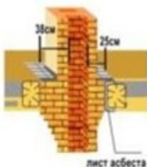
В местах соприкосновения печи или дымовой трубы со сгораемыми конструкциями дома должны быть устроены кирпичные разделки толщиной не менее 38 см; при условии защиты деревянных конструкций асбестом или войлоком, смоченным в глиняном растворе. -25 см.
